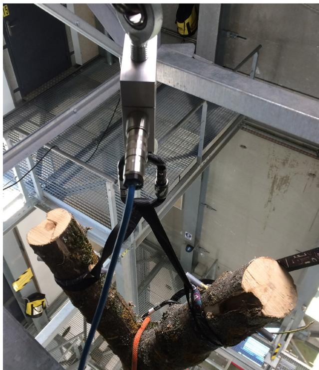
Descripción: Montaje para medir el esfuerzo en una horquilla.
