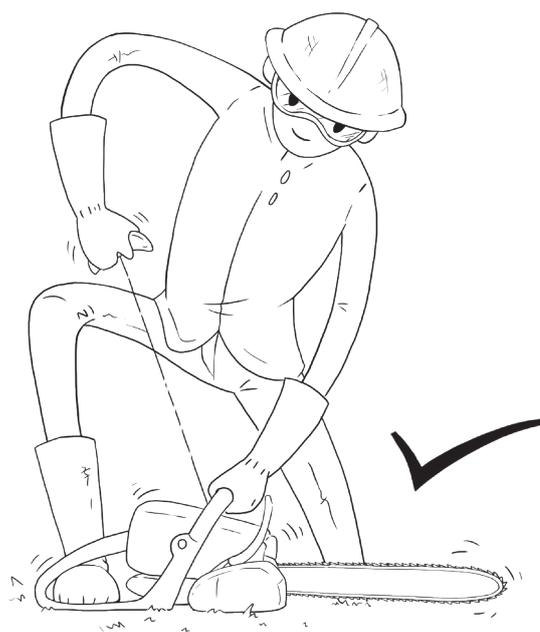
**Segundo método, arrancar con el motor caliente:**
