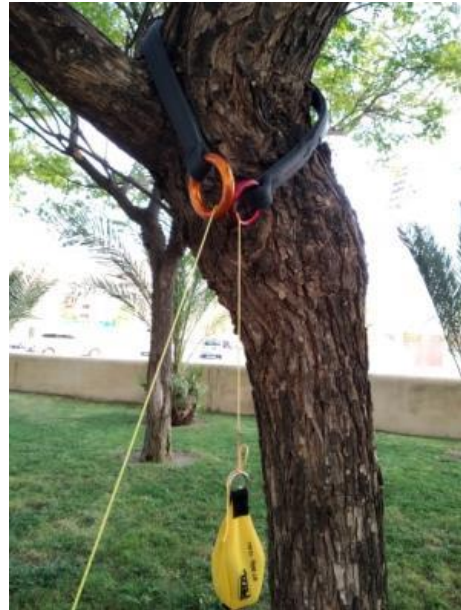
Ilustración 18: Finalización del anclaje estando el trepador en el suelo.
