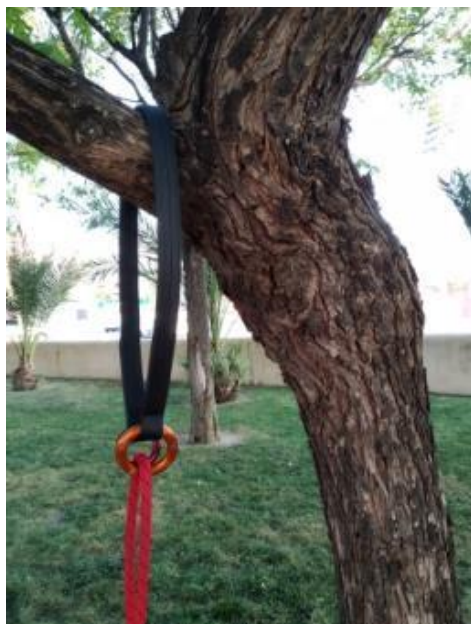
Ilustración 13: Mala elección del lugar de posicionamiento del punto de anclaje.
