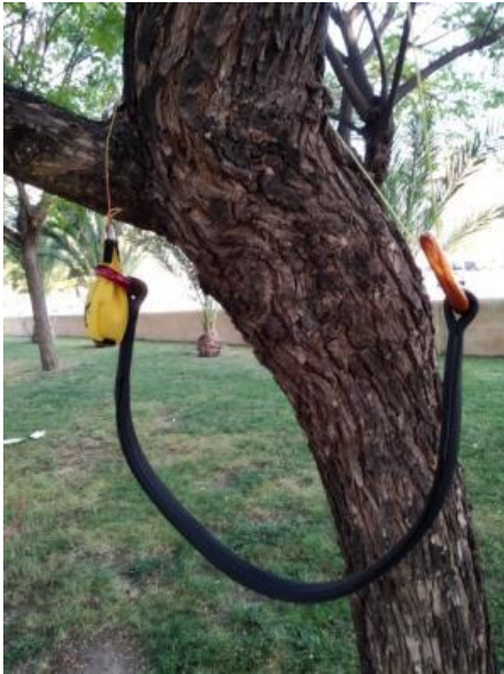
Ilustración 17: Fase inicial de izado del anclaje con la hondilla.
