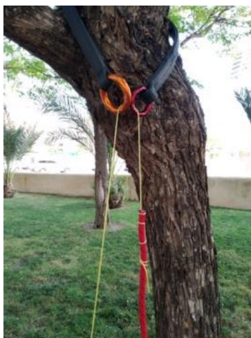
Ilustración 21 1ª fase para la instalación desde el suelo de la cuerda de trabajo/seguridad.
