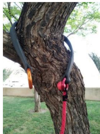
Ilustración 27: 3º la bola pasa por dentro de la anilla más grande del anclaje y se bloquea por la otra anilla más pequeña provocando su desinstalación desde el suelo.
