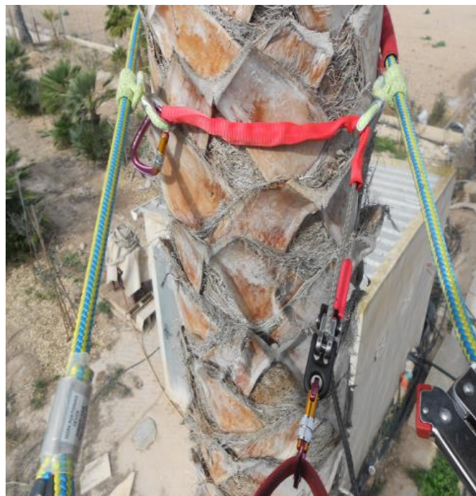
Imagen 17: Configuración de sistema de trepa con Protection Escapettor
