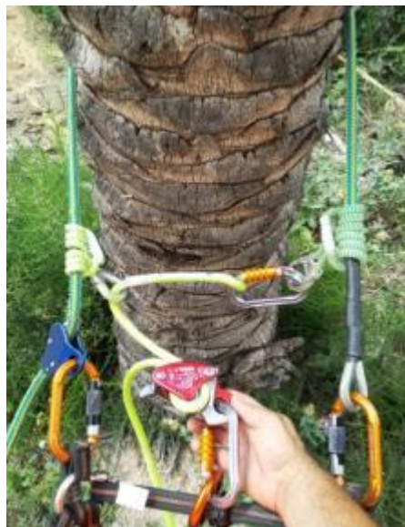
Imagen 11: Instalación dispositivo de regulación de cuerda - ejemplo 1
