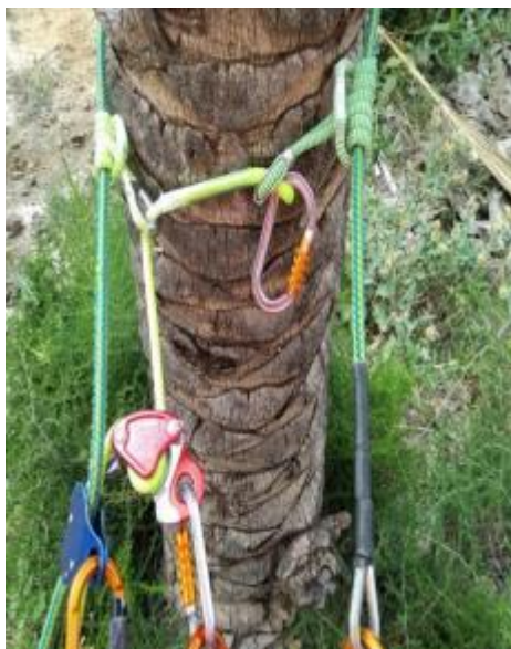
Imagen 10: Configuración de trepa de palmeras ajustada al estípote
