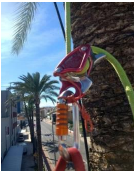
Imagen 21: Descensor/bloqueador Druid, recomendable por su ligereza y su escaso volumen
