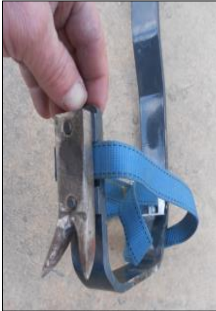
Imagen 25: Espuela de doble púa invertida y puntas romas
