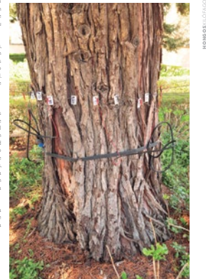
Tomografía de impedancia eléctrica realizada en Eucalyptus globulus con objeto de conocer el estado interno del árbol en su base.
