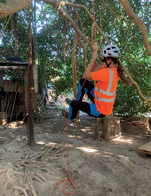
Fotografías 2 y 3. Validando el anclaje con el peso de una persona. Validando el anclaje con el peso de dos personas.
