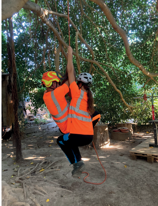
Fotografías 2 y 3. Validando el anclaje con el peso de una persona. Validando el anclaje con el peso de dos personas.
